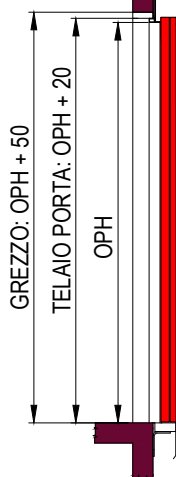
SEZIONE PORTA CON TELAIIO DA 20mm (E1120)
