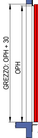
SEZIONE PORTE SENZA TELAIIO (E1120)
