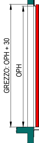
SEZIONE PORTE SENZA TELAIO (EI120)
