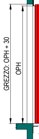
SEZIONE PORTE SENZA TELAIO (EI120)
