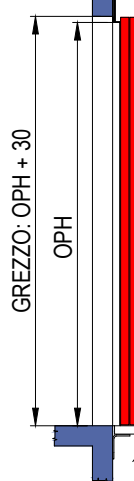
SEZIONE PORTE SENZA TELAIO (E1120)
