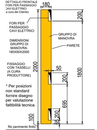
Le opere murarie della parete frontale al piano del gruppo di manovra vanno realizzate dopo il montaggio dell'impianto, della posa delle porte di piano e del gruppo di manovra.
