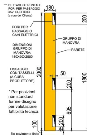
Le opere murarie della parete frontale al piano del gruppo di manovra vanno realizzate dopo il montaggio dell'impianto, della posa delle porte di piano e del gruppo di manovra.
