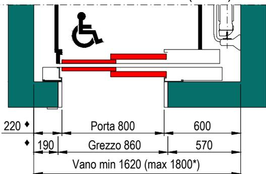
\* E' POSSIBILE AUMENTARE LE DIMENSIONI DEL VANO FINO AI VALORI MASSIMI INDICATI. PER VANI CON DIMENSIONI COMPRESSE TRA I VALORI MINIMI E MASSIMI, AUMENTARE TUTTE LE QUOTE INDICATE CON ♦ DELLA DIFFERENZA CON IL VALORE MINIMO. LA DIMENSIONE DELLA TESTATA È GARANTITA PER VANI CON DIMENSIONI COMPRESSE TRA I VALORI MINIMI E MASSIMI. PER VANI CON DIMENSIONI MAGGIORI CONTATTARE LA DITTA PRODUTTRICE.
