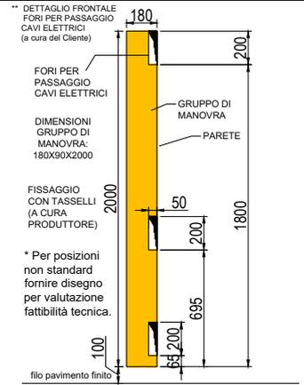
Le opere murarie della parete frontale al piano del gruppo di manovra vanno realizzate dopo il montaggio dell'impianto, della posa delle porte di piano e del gruppo di manovra.
