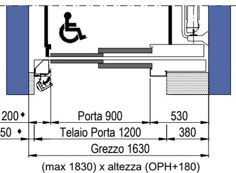
Le opere murarie della parete frontale al piano del gruppo di manovra vanno realizzate dopo il montaggio dell'impianto, della posa delle porte di piano e del gruppo di manovra.
