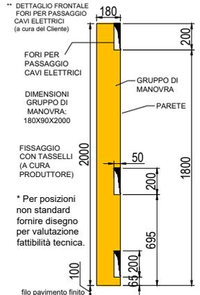
Le opere murarie della parete frontale al piano del gruppo di manovra vanno realizzate dopo il montaggio dell'impianto, della posa delle porte di piano e del gruppo di manovra.
