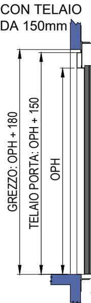
SEZIONE VANO CORSA
