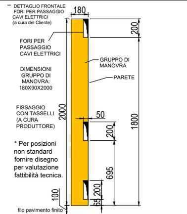
Le opere murarie della parete frontale al piano del gruppo di manovra vanno realizzate dopo il montaggio dell'impianto, della posa delle porte di piano e del gruppo di manovra.
