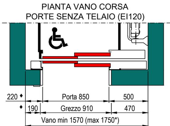
\* E' POSSIBILE AUMENTARE LE DIMENSIONI DEL VANO FINO AI VALORI MASSIMI INDICATI. PER VANI CON DIMENSIONI COMPRESSE TRA I VALORI MINIMI E MASSIMI, AUMENTARE TUTTE LE QUOTE INDICATE CON ♦ DELLA DIFFERENZA CON IL VALORE MINIMO. LA DIMENSIONE DELLA TESTATA È GARANTITA PER VANI CON DIMENSIONI COMPRESSE TRA I VALORI MINIMI E MASSIMI. PER VANI CON DIMENSIONI MAGGIORI CONTATTARE LA DITTA PRODUTTRICE.
