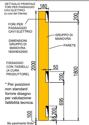
Le opere murarie della parete frontale al piano del gruppo di manovra vanno realizzate dopo il montaggio dell'impianto, della posa delle porte di piano e del gruppo di manovra.
