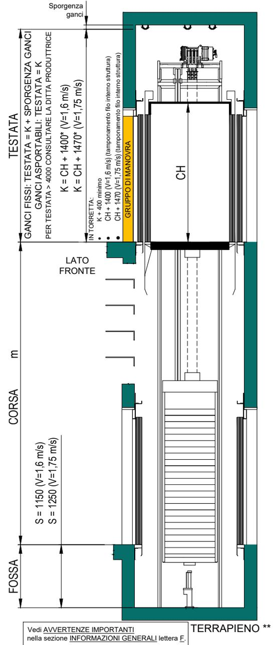
\* E' POSSIBILE AUMENTARE LE DIMENSIONI DEL VANO FINO AI VALORI MASSIMI INDICATI. PER VANI CON DIMENSIONI COMPRESSE TRA I VALORI MINIMI E MASSIMI, AUMENTARE TUTTE LE QUOTE INDICATE CON ♦ DELLA DIFFERENZA CON IL VALORE MINIMO. LA DIMENSIONE DELLA TESTATA È GARANTITA PER VANI CON DIMENSIONI COMPRESSE TRA I VALORI MINIMI E MASSIMI. PER VANI CON DIMENSIONI MAGGIORI CONTATTARE LA DITTA PRODUTTRICE.
