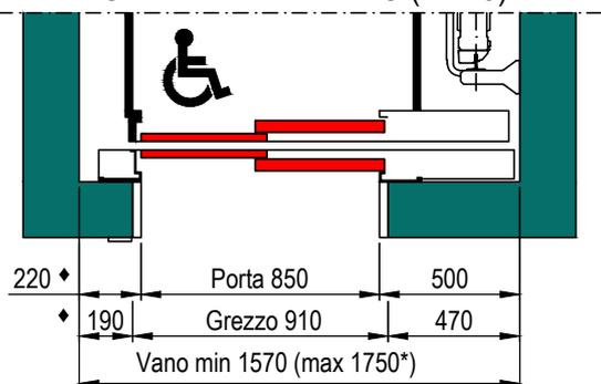
SEZIONE VANO CORSA
