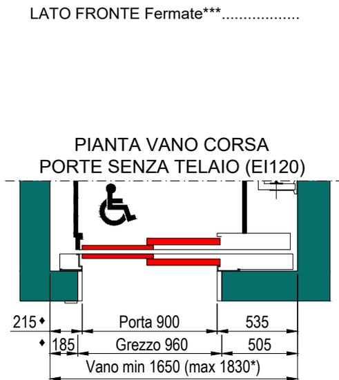
\* E' POSSIBILE AUMENTARE LE DIMENSIONI DEL VANO FINO AI VALORI MASSIMI INDICATI. PER VANI CON DIMENSIONI COMPRESSE TRA I VALORI MINIMI E MASSIMI, AUMENTARE TUTTE LE QUOTE INDICATE CON ♦ DELLA DIFFERENZA CON IL VALORE MINIMO. LA DIMENSIONE DELLA TESTATA È GARANTITA PER VANI CON DIMENSIONI COMPRESSE TRA I VALORI MINIMI E MASSIMI. PER VANI CON DIMENSIONI MAGGIORI CONTATTARE LA DITTA PRODUTTRICE.
