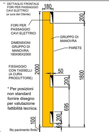
Le opere murarie della parete frontale al piano del gruppo di manovra vanno realizzate dopo il montaggio dell'impianto, della posa delle porte di piano e del gruppo di manovra.
