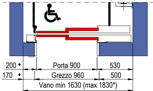
\* E' POSSIBILE AUMENTARE LE DIMENSIONI DEL VANO FINO AI VALORI MASSIMI INDICATI. PER VANI CON DIMENSIONI COMPRESSE TRA I VALORI MINIMI E MASSIMI, AUMENTARE TUTTE LE QUOTE INDICATE CON ♦ DELLA DIFFERENZA CON IL VALORE MINIMO. LA DIMENSIONE DELLA TESTATA È GARANTITA PER VANI CON DIMENSIONI COMPRESSE TRA I VALORI MINIMI E MASSIMI. PER VANI CON DIMENSIONI MAGGIORI CONTATTARE LA DITTA PRODUTTRICE.
