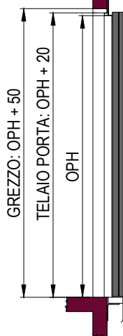
SEZIONE PORTA CON TELAIO DA 20mm (EI120)
