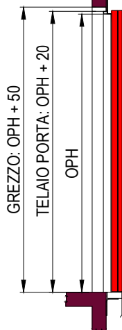
SEZIONE PORTA CON TELAIO DA 20mm (EI120)
