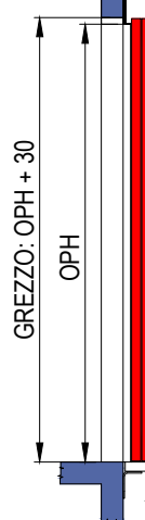
SEZIONE PORTE SENZA TELAIIO (E1120)
