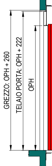
SEZIONE PORTA CON TELAIO DA 90mm (EI60 - EI120)
