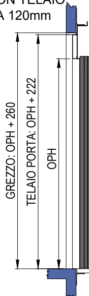
SEZIONE PORTA CON TELAIO DA 90mm (EI60 - EI120)
